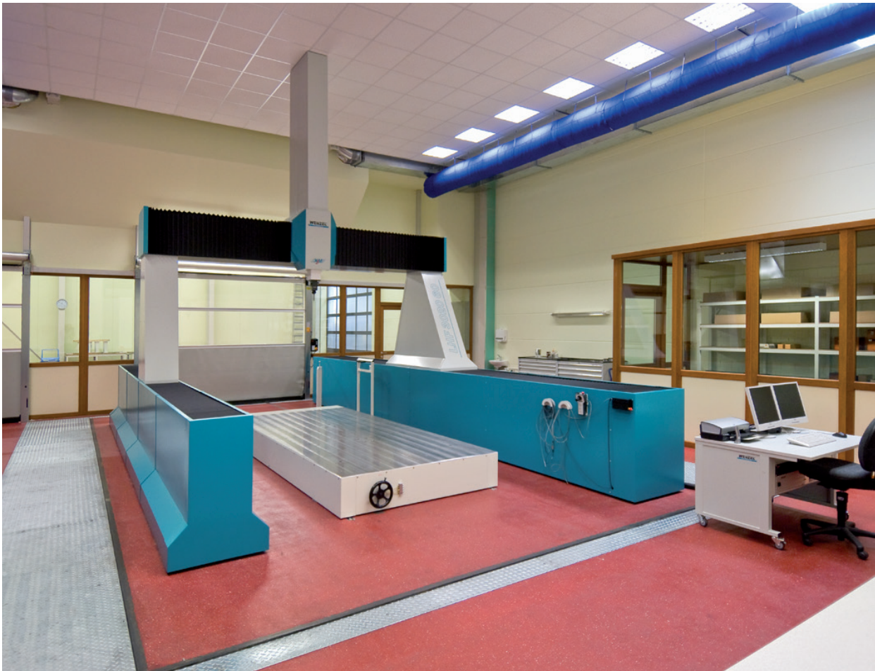
3D-Koordinaten-Messmaschine LHF 30-60-20 auf aktiv gedämpftem Fundament im vollklimatisierten Raum
